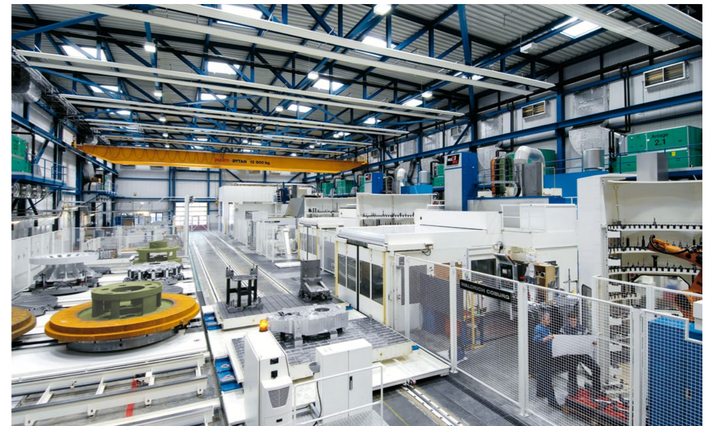
Klimatisierte Fertigungshalle für hochpräzise Teile bis 25 Tonnen und 4.5 Meter
