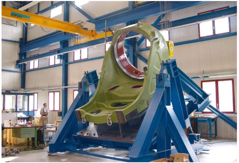
Hebe- und Kippvorrichtung zur einfachen Montage schwerer Teile
