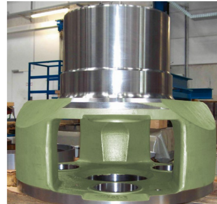
Bearbeitung von Planetenträgern und anderen Komponenten
