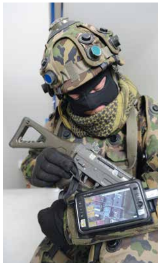
Système de localisation intérieure avec affichage fixé au poignet
